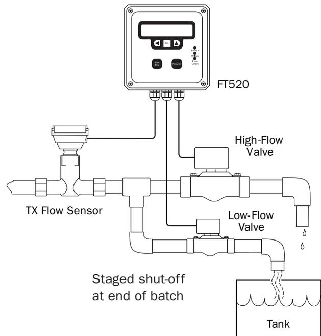
**CONNECTION FOR STAGED SHUT-OFF**
